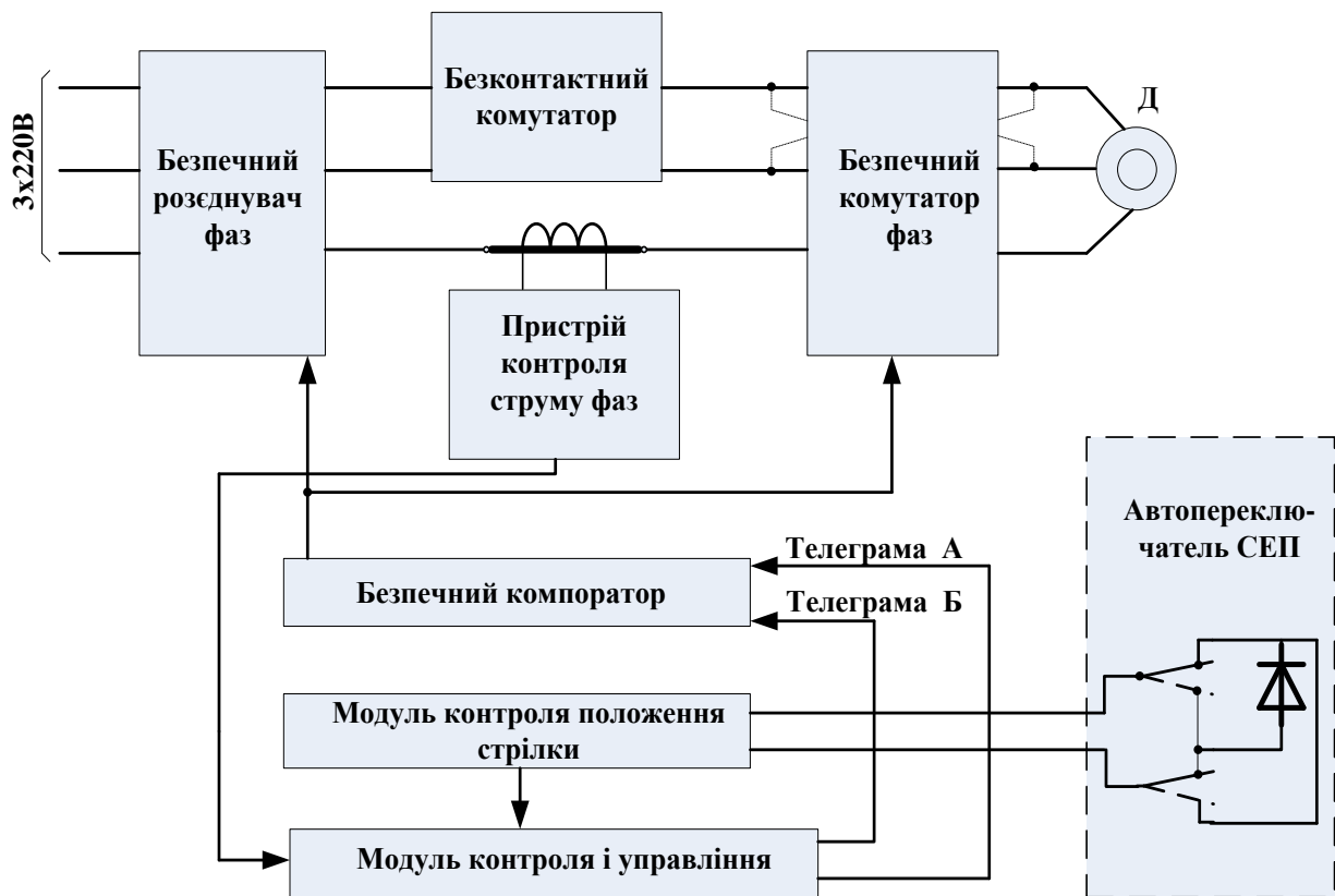
Рис. 1. Структурна схема комутації робочого кола стрілочного електропривода МПЦ Ebilock
