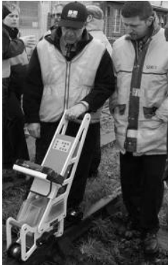
Рис. 3. Техніка ультразвукової дефектоскопії [1]
