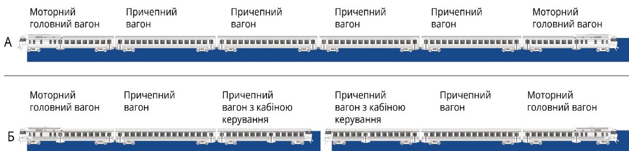
Рис. 2. Компоновка складу дизель-поїзда ДР-1А:
