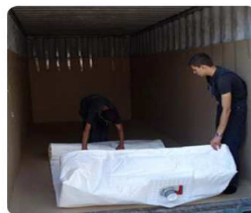
Рис. 3. Підготовка контейнера та укладання флексітанка в контейнер
