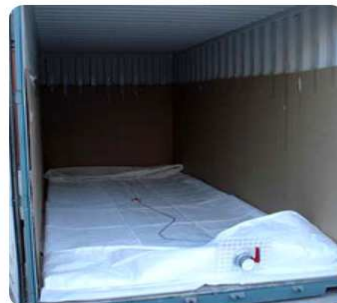
Рис. 4. Вирівнювання положення флексітанка в контейнері та підготовка флексітанка для встановлення щита
