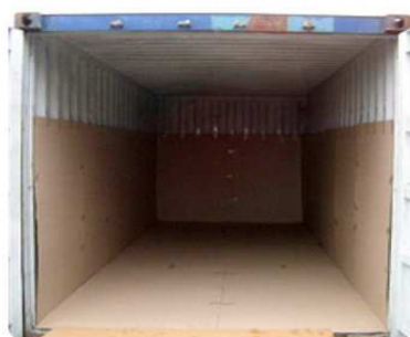
Рис. 3. Підготовка контейнера та укладання флексітанка в контейнер
