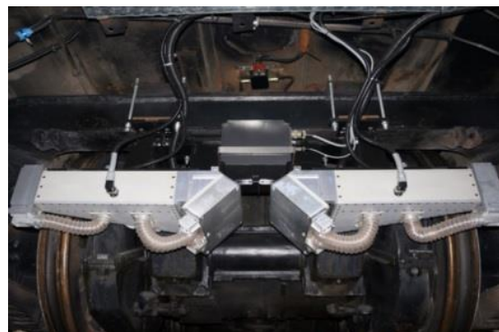
Рис. 4. Автомотриса SRS 141 виробництва SPERRY та автоматизована телевізійна візуально-вимірвальна система [8]
