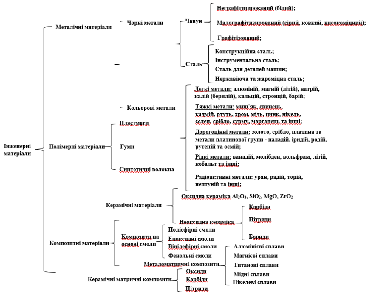
Рис. 1. Ієрархічна структура інженерних матеріалів
