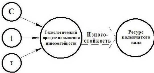
Рис. 1. Граф технологического процесса повышения износостойкости коленчатого вала транспортного двигателя:
