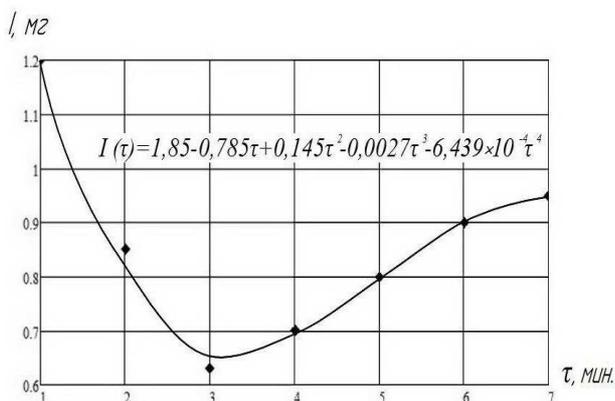
Рис. 2. Зависимость величины износа поверхности шейки коленчатого вала от времени выдержки в растворе
