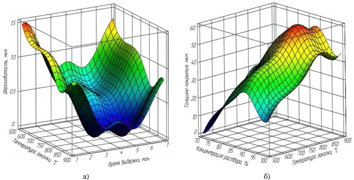
Рис. 6. Зависимость шероховатости (а) и толщины покрытия (б) от времени выдержки, концентрации раствора и температуры закалки
