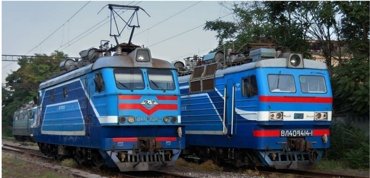
Рис. 3. Модернізовані електровози ВЛ40у: зліва модернізація ЗЕРЗ, справа модернізація ЛЛРЗ
